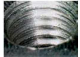
Macho de corte con capa de TiCN en AISI7
