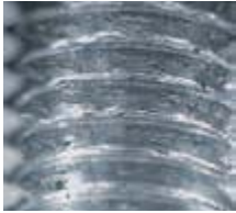
Superficie exfoliada por lubricación insuficiente; Solución: ranuras de lubricación
