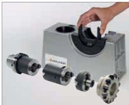
4. Introducción de la brida ciega V 530 en la brida V 510.10.050
