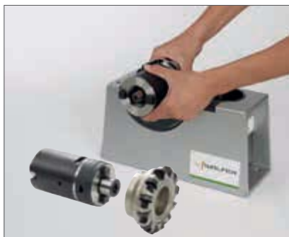
8. Introducción del cono base en la brida correspondiente
