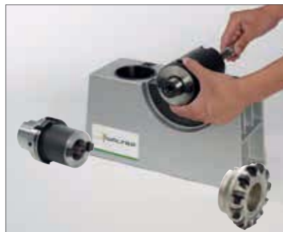
6. Atornillado manual de la prolongación y del acoplamiento de la fresa mediante la llave tubular
