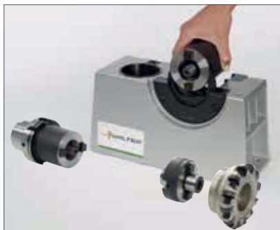
5. Introducción de la prolongación en la brida ciega
