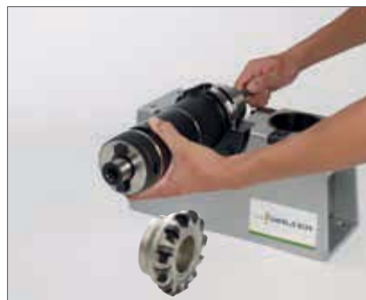
9. Enroscar los elementos NC-Tool con el cono base
