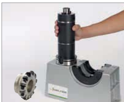
11. Introducción de la fijación de herramienta montada en el cono rápido
